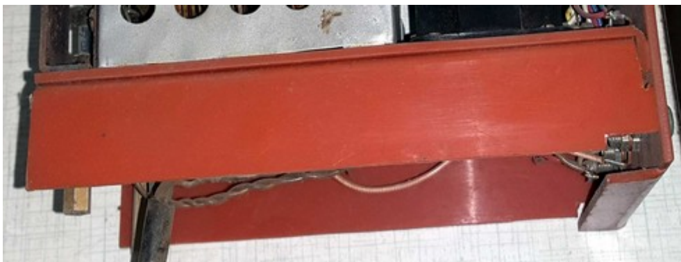
Bild 5: Chassiskonstruktion aus PVC (Teilansicht)
