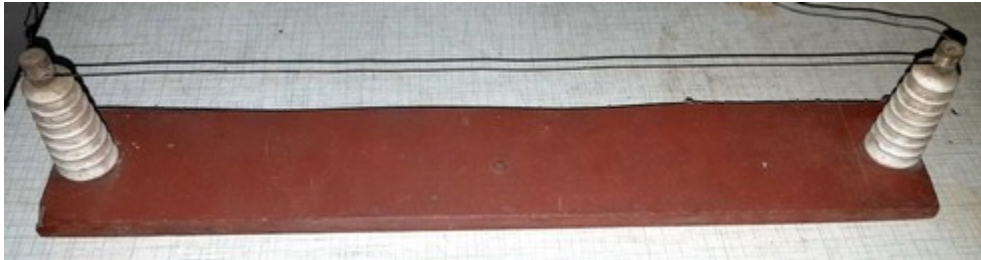
Bild 6: Biegewerkzeug für PVC
