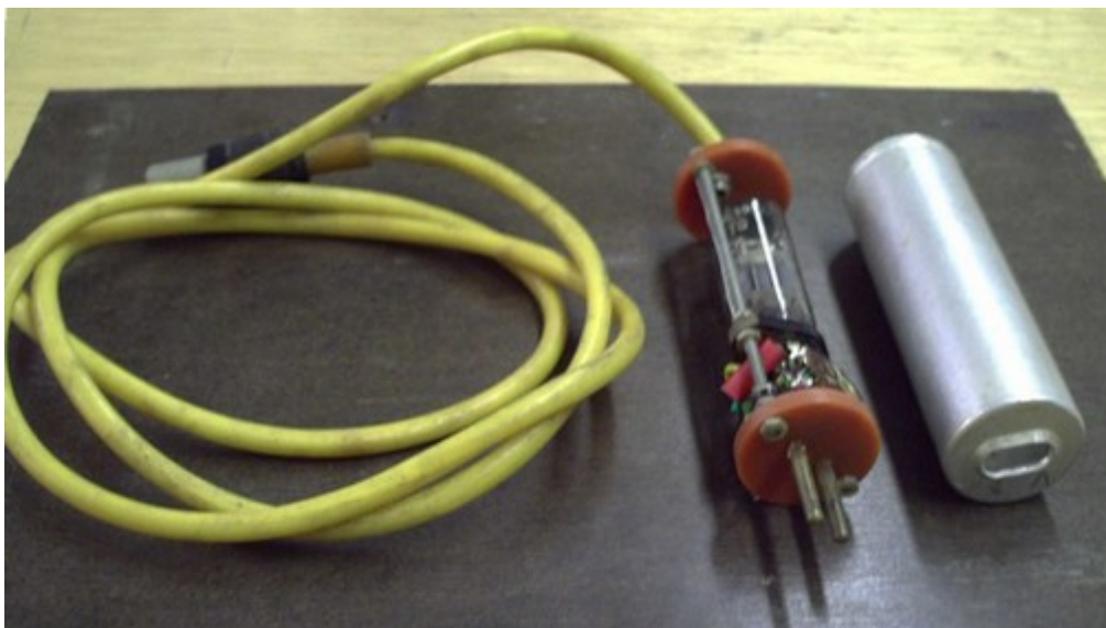
Bild 3 – Der fertige Tastkopf ist erhalten geblieben und wurde dem Industriesalon Schöneweide übergeben (als außergewöhnliches Anwendungsbeispiel für die Röhre EABC80, die im VEB Werk für Fernsehelektronik hergestellt wurde)
