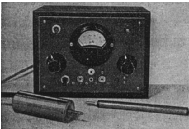
Bild 1: Das fertige Röhrenvoltmeter (Bild ist aus der "Radio und Fernsehen")
