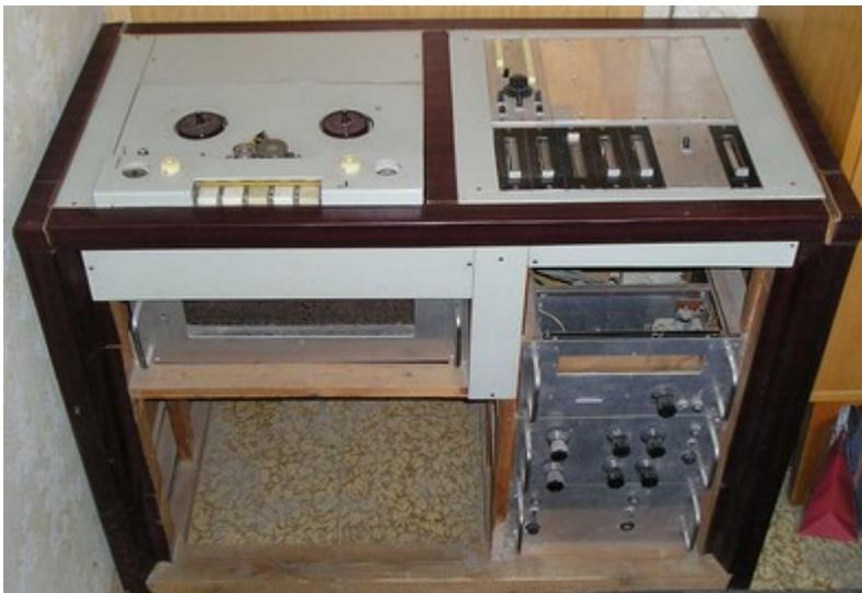
Angeregt durch die technische Realisierung solcher kommerziellen Anlagen und die der industriellen Gefäßtechnologien, mit denen ich täglich in unserer Elektronik-Werkstatt zu tun durfte, konzipierte ich ein modulares, auf Basis von Einschüben bestehendes System.
